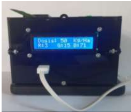
Gambar 11. Input Daun Padi pada Alat dan Identifikasi Dosis Pupuk Nitrogen
